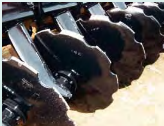
Bras renforcés sur sécurité élastomère Reinforced arms on rubber suspension. Verstärkten-Arme mit Elastomen Sicherheitsvorrichtung
