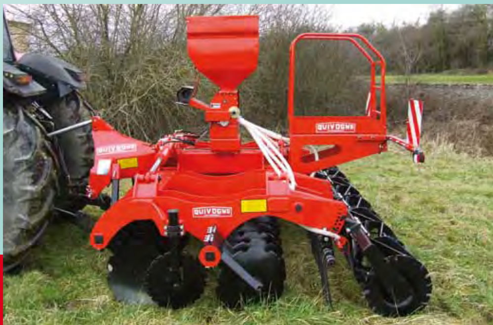
Bras renforcés sur sécurité élastomère Reinforced arms on rubber suspension. Verstärkten-Arme mit Elastomen Sicherheitsvorrichtung
