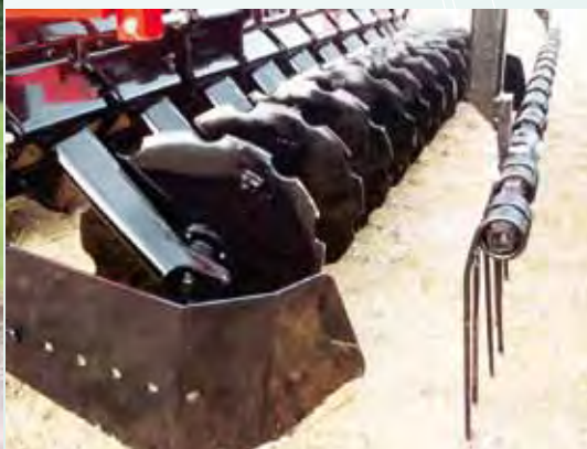
Herse à peignes ø 10 mm Rake harrow ø 10 mm Striegelegge ø 10mm
